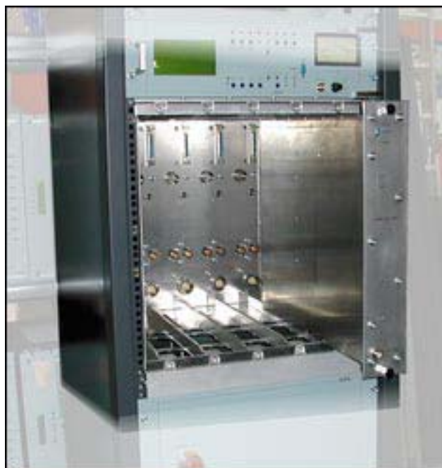
Figura 5-2 Inserción de los módulos de RF
