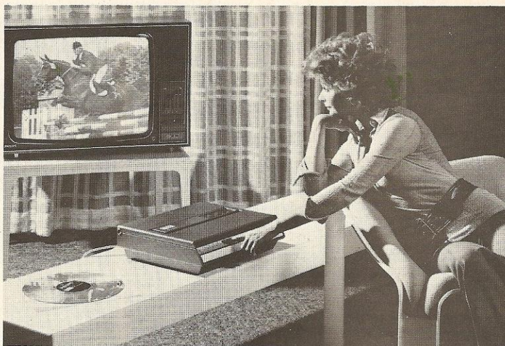
Een televisieprogramma van ruim een half uur in kleur en met HiFi-stereofonisch geluid, ondergebracht op een videoplaaat met de afmetingen van een gewone langspeelgrammofoonplaat. Dat is in kort bestek het door Philips geïntroduceerde VLP-systeem (Video Long Play).
